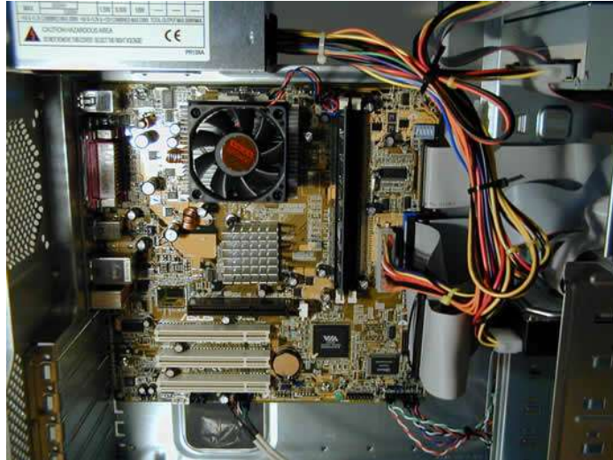
Gambar 19. Memasukkan Motherboard dalam Casing
